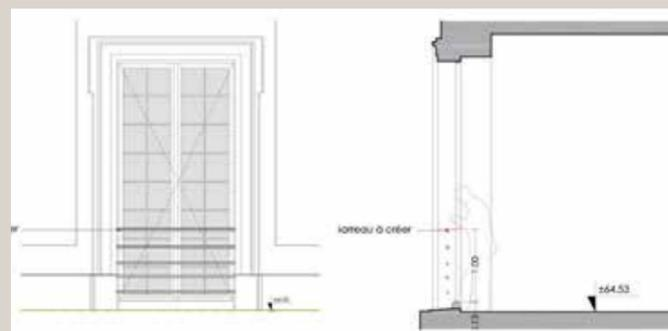
Schéma de principe de la nouvelle solution proposée : seulement 5 lisses espacées de 18 cm (© Architecture & Heritage et Alain del Zotto, architectes).
