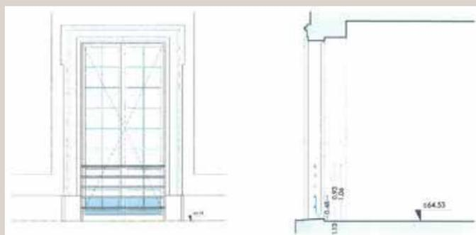
Schéma de principe de la première solution proposée : 5 lisses espacées de 18 cm et un panneau de Stadip dans la partie basse (© Architecture & Heritage et Alain del Zotto, architectes).
