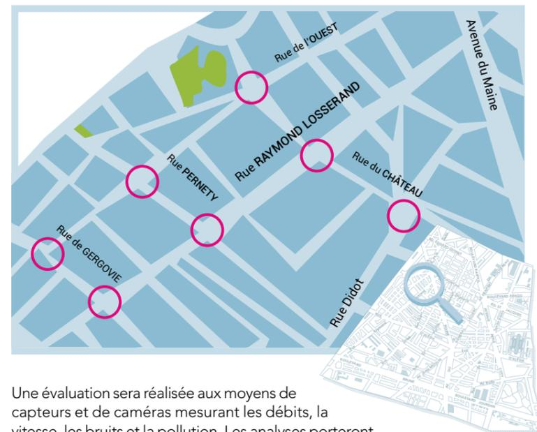
Une évaluation sera réalisée aux moyens de capteurs et de caméras mesurant les débits, la vitesse, les bruits et la pollution. Les analyses porteront sur la vitesse des véhicules en fonction de l'état des feux, le niveau sonore en journée et la nuit, le respect des feux, le non-respect des priorités piétons dans les mouvements tournants, le nombre de piétons traversant au rouge piéton et le phénomène d'« appel au vert ». L'évaluation de cette expérimentation sera rendue publique en juin 2018.
