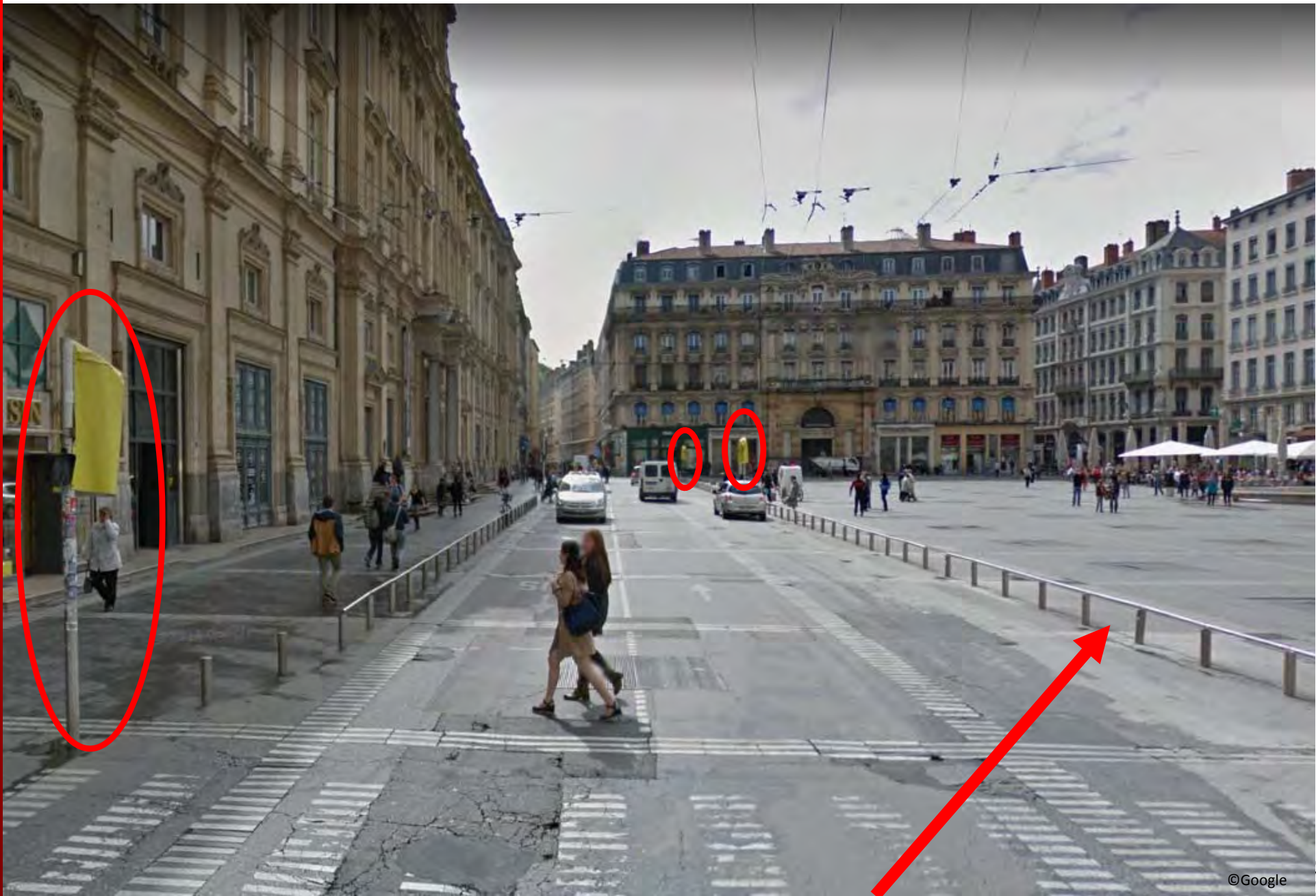
Barrières continues canalisant les piétons
