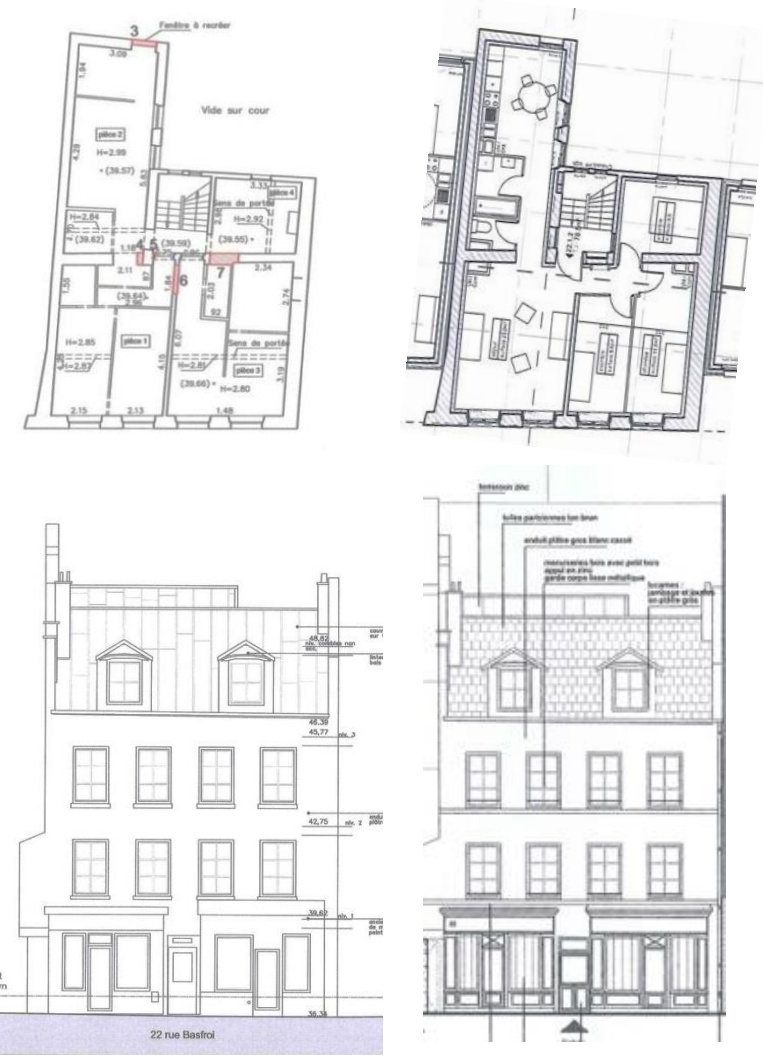
Ci-dessus : plan des démolition et de l'état projeté du 1 er étage ; élévation existante et projetée de la façade rue. Ci-dessous : à gauche, perspective d'insertion du projet ; plan du projet global et élévation des façades projetées. (© rh+ architecture)
