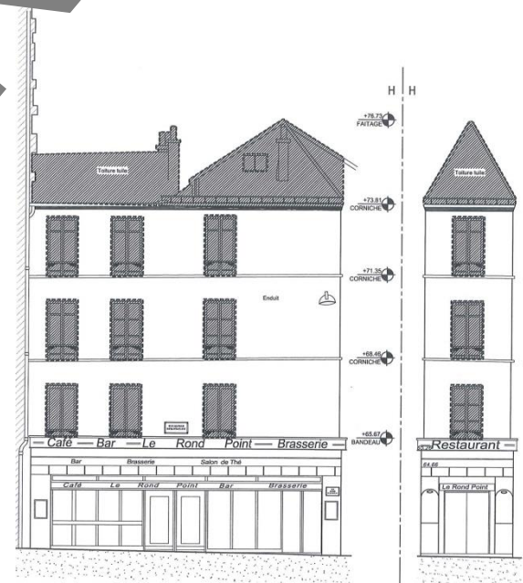
Ci-dessous, de haut en bas : état actuel et état projeté vus depuis le carrefour de l'angle des rues Raymond Losserand et Alfred Durand-Claye. Un étage est ajouté et une enveloppe de briques bicolores est envisagée afin d'assurer une isolation extérieure.
