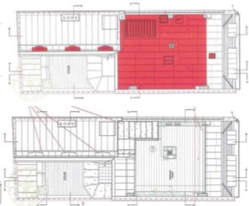
Ci-dessus, à gauche : coupe longitudinale de l'hôtel montrant les démolitions demandées (création de lucarnes sur l'aile en retour, et démolition d'une partie de la toiture côté cour) ; à droite, de haut en bas : plans de toiture montrant les démolitions demandées et l'état projeté.
