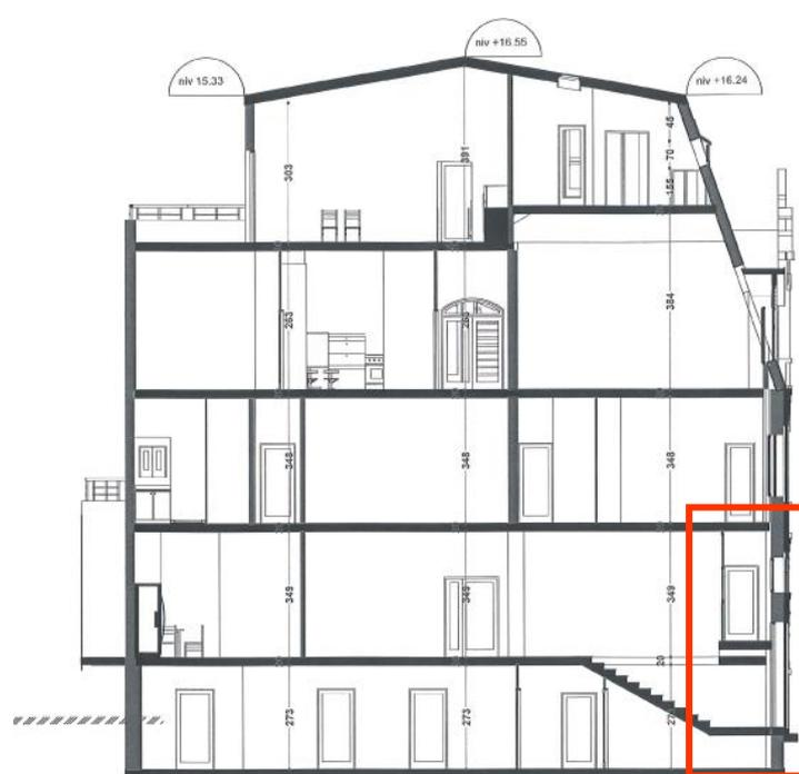
Ci-dessus, de gauche à droite : coupes actuelle et projetée. L'état projeté annonce à rez-de-chaussée une passerelle de franchissement de l'entrée, de nouveaux cloisonnements et la surélévation du comble avec création d'une terrasse accessible à l'arrière qui ferait disparaître l'éclairage zénithal de l'escalier.
