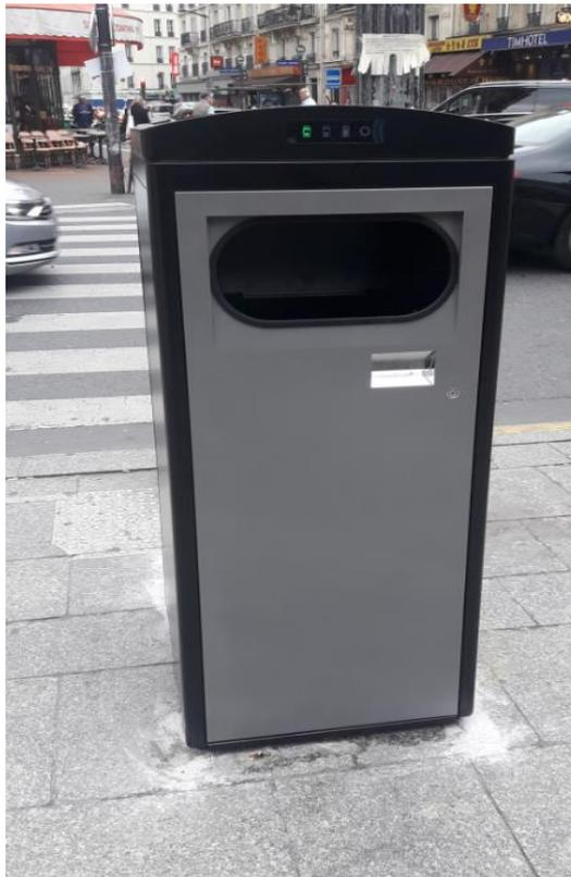
La mairie a mis en test deux modèles différents sur la gare du Nord et sur la Place de la République. Ces corbeilles sont compactantes et communicantes grâce à des panneaux solaires. Elles sont aussi équipées soit d'un éteignoir soit d'un cendrier.
