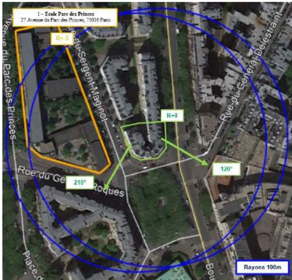
Adresses des établissements particuliers dont l'emprise est située à moins de 100 m et estimation du champ maximum reçu des antennes à faisceaux fixes dans chacun d'entre eux
