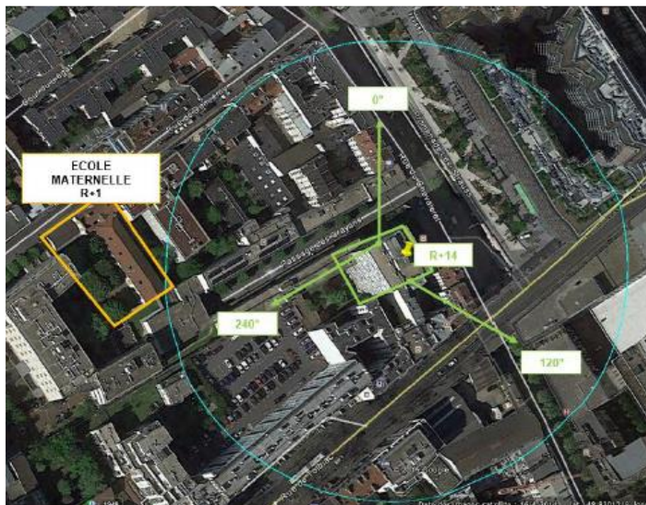
Adresses des établissements particuliers dont l'emprise est située à moins de 100 m et estimation du champ maximum reçu des antennes à faisceaux orientables dans chacun d'entre eux
