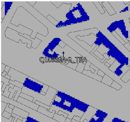
Pour l'antenne orientée dans l'azimut 120°, le niveau maximal calculé est compris entre 0 et 1 V/m. La hauteur correspondante est de 19.5m.
