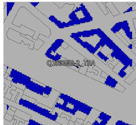
Pour l'antenne orientée dans l'azimut 240°, le niveau maximal calculé est compris entre 1 et 2 V/m. La hauteur correspondante est de 25.5m.
