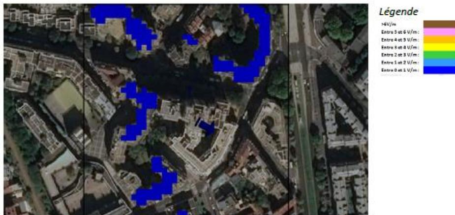
Pour les antennes à faisceau orientable dans l'azimut 240°, le niveau maximal calculé est compris entre 0 et 1 V/m . La hauteur correspondante est de 34.5 m .
