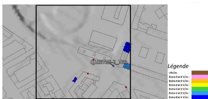
**Pour l'antenne orientée dans l'azimut 240°, le niveau maximal calculé est compris entre 0 et 1 V/m. La hauteur correspondante est de 19.5m.**
