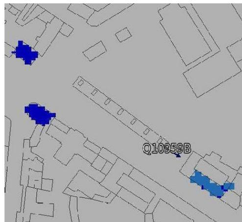
Pour l'antenne orientée dans l'azimut 240°, le niveau maximal calculé est compris entre 1 et 2 V/m. La hauteur correspondante est de 28.5m.
