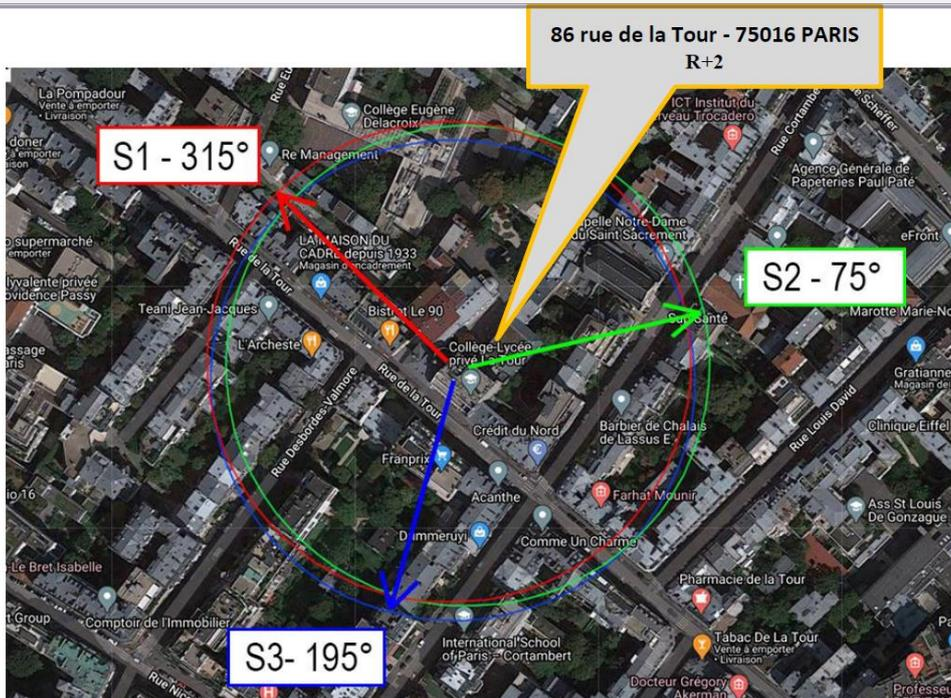
**Estimation des antennes à faisceaux orientables**
