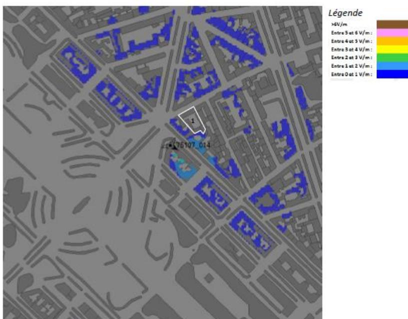
Pour l'antenne à faisceau orientable dans l'azimut 260°, le niveau maximal calculé en intérieur est compris entre 0 et 1 V/m. La hauteur correspondante est de 28 m.
