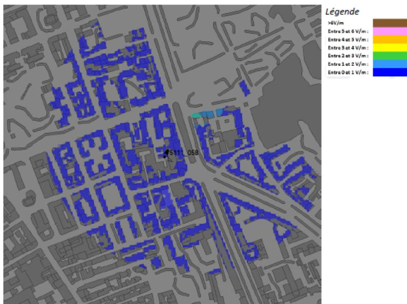
Pour l'antenne à faisceau orientable dans l'azimut 120°, le niveau maximal calculé en intérieur est compris entre 2 et 3 V/m. La hauteur correspondante est de 19 m.
