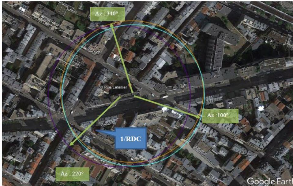
Estimation des antennes à faisceaux orientables
