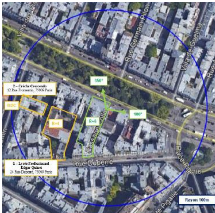
Adresses des établissements particuliers dont l'emprise est située à moins de 100 m et estimation du champ maximum reçu des antennes à faisceaux fixes dans chacun d'entre eux
