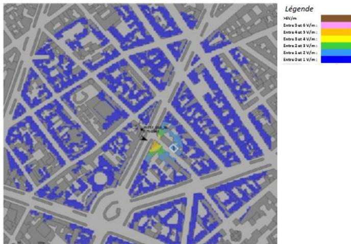
Pour l'antenne à faisceau fixe orientée dans l'azimut 270°, le niveau maximal calculé en intérieur est compris entre 4 et 5 V/m. La hauteur correspondante est de 23 m.
