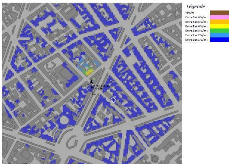
Pour l'antenne à faisceau fixe orientée dans l'azimut 110°, le niveau maximal calculé en intérieur est compris entre 4 et 5 V/m. La hauteur correspondante est de 19 m.
