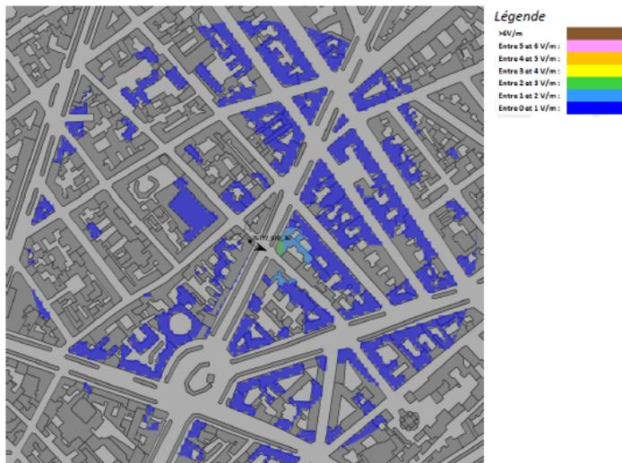
Pour l'antenne à faisceau orientable dans l'azimut 270°, le niveau maximal calculé en intérieur est compris entre 3 et 4 V/m. La hauteur correspondante est de 23 m.
