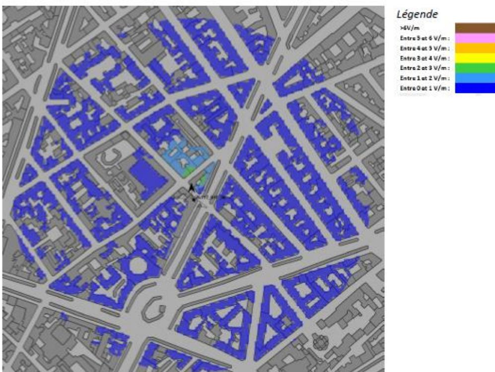
Pour l'antenne à faisceau orientable dans l'azimut 110°, le niveau maximal calculé en intérieur est compris entre 2 et 3 V/m. La hauteur correspondante est de 24 m.
