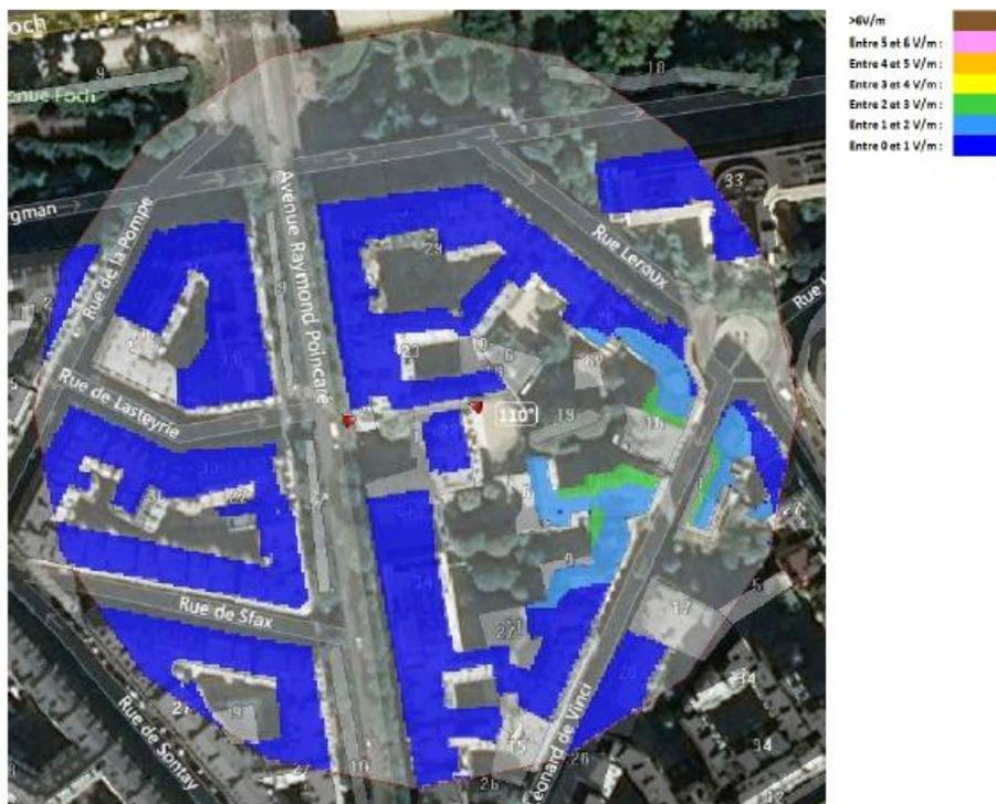
Pour l'antenne orientée dans l'azimut 255°, le niveau maximal calculé est compris entre 4 et 5V/m. La hauteur correspondante est de 25.50m.
