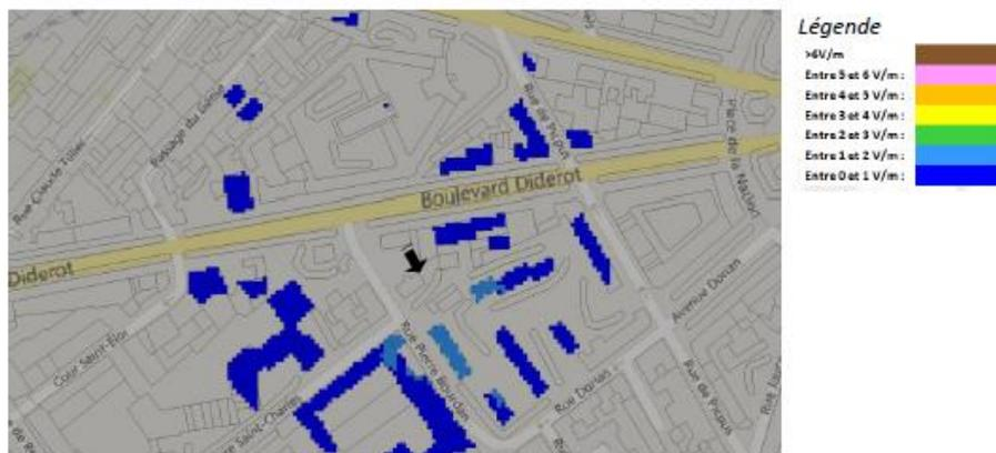
Pour l'antenne à faisceau orientable dans l'azimut 270°, le niveau maximal calculé en intérieur est compris entre 1 et 2 V/m. La hauteur correspondante est de 19 m.
