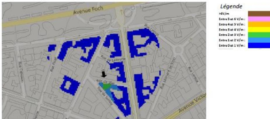
Pour l'antenne à faisceau fixe orientée dans l'azimut 260°, le niveau maximal calculé en intérieur est compris entre 3 et 4 V/m. La hauteur correspondante est de 22 m.
