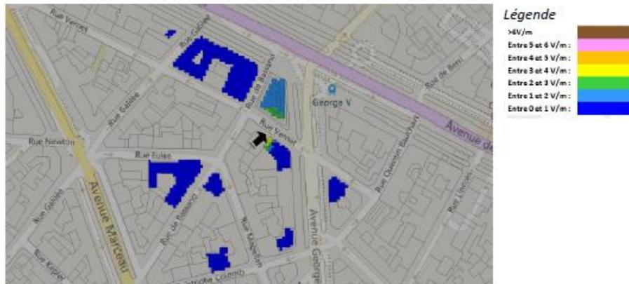
Pour l'antenne à faisceau orientable dans l'azimut 150°, le niveau maximal calculé en intérieur est compris entre 2 et 3 V/m. La hauteur correspondante est de 28 m.
