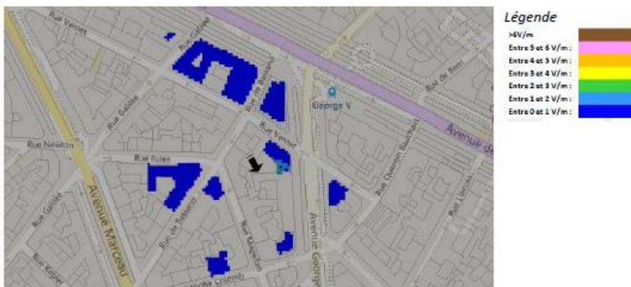
Pour l'antenne à faisceau orientable dans l'azimut 250°, le niveau maximal calculé en intérieur est compris entre 2 et 3 V/m. La hauteur correspondante est de 25 m.
