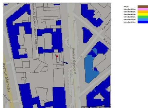
Pour l'antenne orientée dans l'azimut 250°, le niveau maximal calculé est compris entre 2 et 3 V/m. La hauteur correspondante est de 19.5m.
