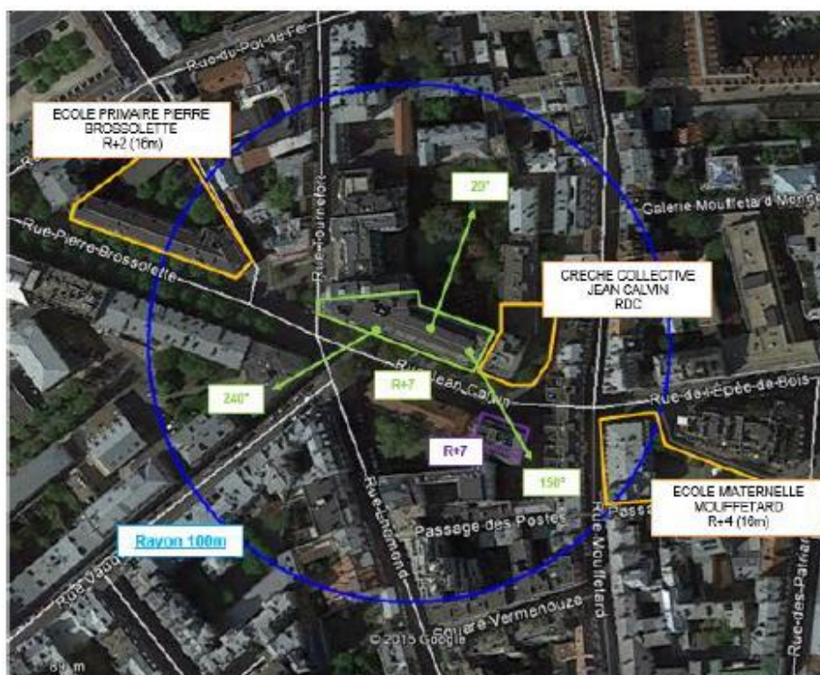
Adresses des établissements particuliers dont l'emprise est située à moins de 100 m et estimation du champ maximum reçu des antennes à faisceaux fixes dans chacun d'entre eux
