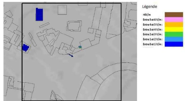
Pour l'antenne orientée dans l'azimut 240°, le niveau maximal calculé est compris entre 1 et 2 V/m. La hauteur correspondante est de 19.5m.
