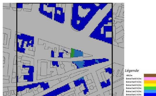
Pour l'antenne orientée dans l'azimut 240°, le niveau maximal calculé est compris entre 3 et 4 V/m. La hauteur correspondante est de 25.5m.
