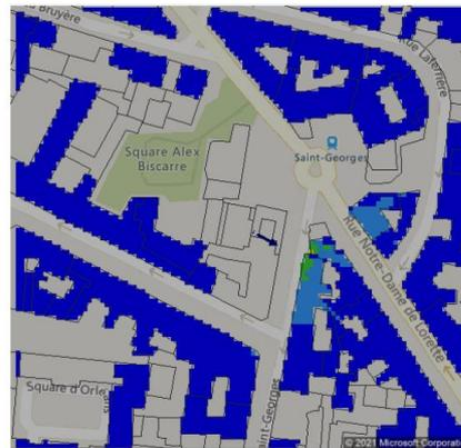
Pour l'antenne orientée dans l'azimut 233°, le niveau maximal calculé est compris entre 3 et 4 V/m. La hauteur correspondante est de 22.5m.
