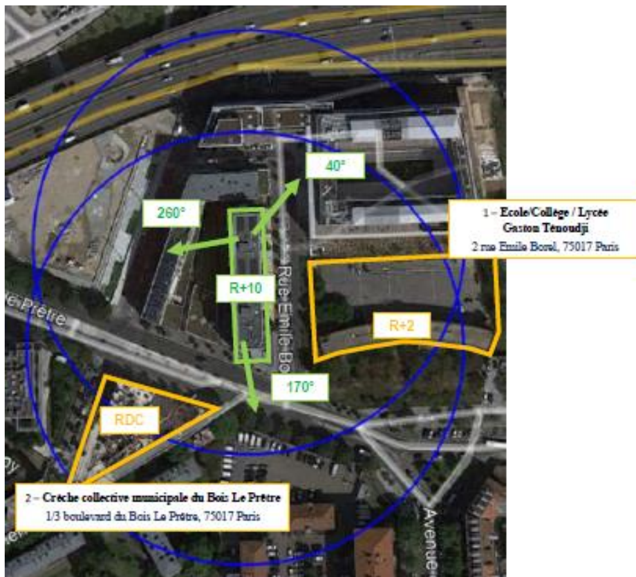
Adresses des établissements particuliers dont l'emprise est située à moins de 100 m et estimation du champ maximum reçu des antennes à faisceaux fixes dans chacun d'entre eux
