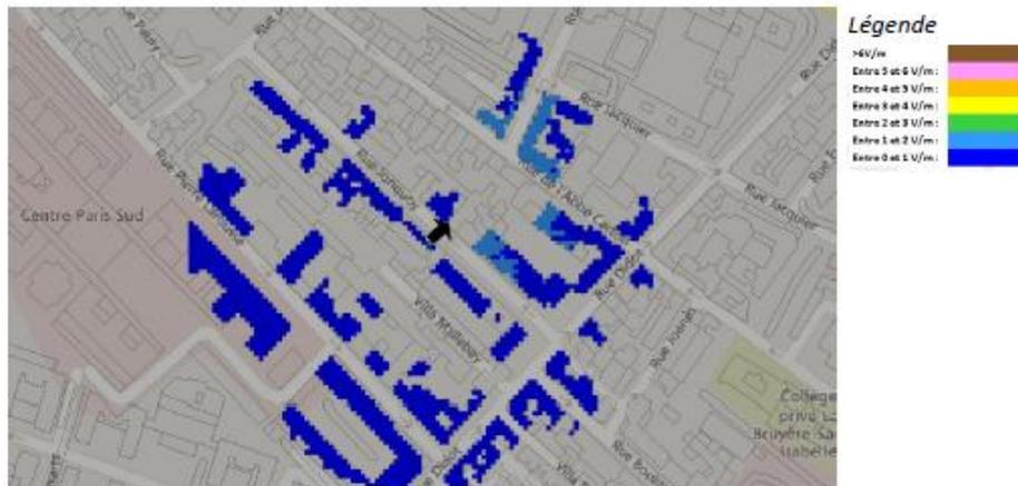
Pour les antennes à faisceau fixe orientées dans l'azimut  $170^\circ$ , le niveau maximal calculé est compris entre 2 et 3 V/m . La hauteur correspondante est de 19.5 m .
