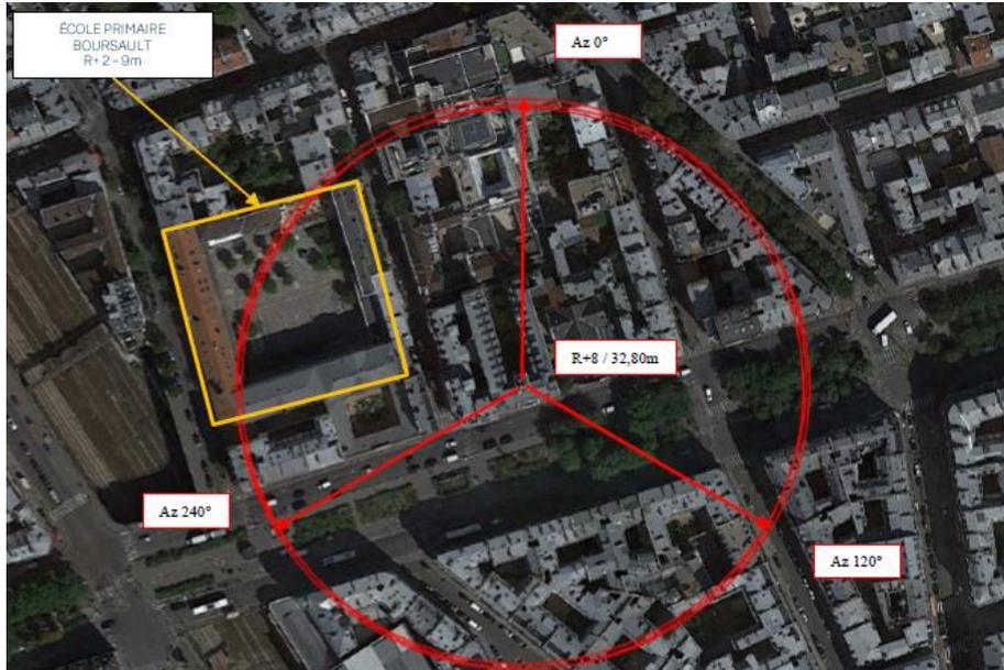
**Estimation des antennes à faisceaux orientables**
