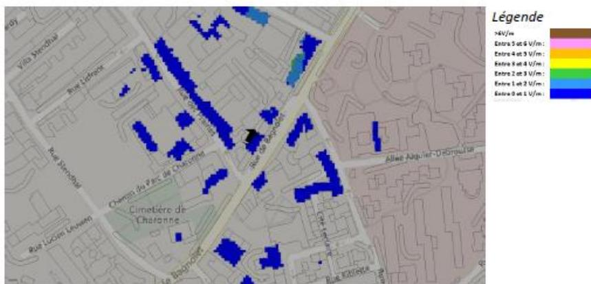
Pour les antennes à faisceau fixe orientées dans l'azimut 150°, le niveau maximal calculé est compris entre 1 et 2 V/m. La hauteur correspondante est de 19.5 m.
