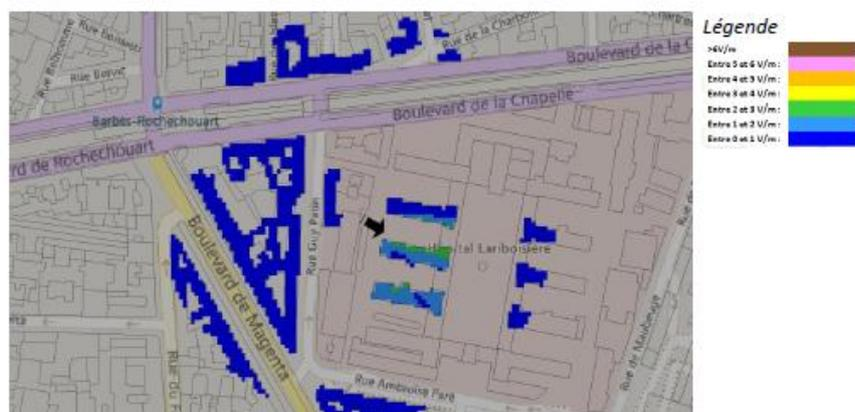
Pour les antennes à faisceau fixe orientées dans l'azimut 240°, le niveau maximal calculé est compris entre 2 et 3 V/m . La hauteur correspondante est de 19.5 m .
