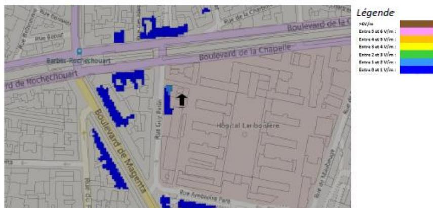
Pour les antennes à faisceau fixe orientées dans l'azimut 120°, le niveau maximal calculé est compris entre 2 et 3 V/m . La hauteur correspondante est de 19.5 m .
