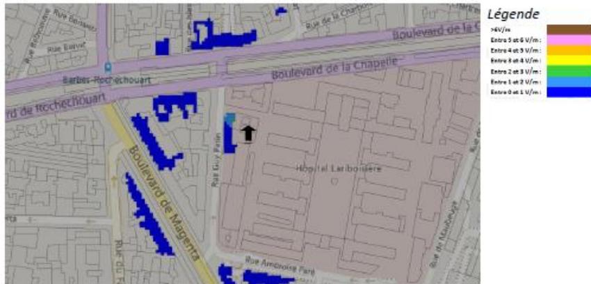
Pour les antennes à faisceau orientable dans l'azimut 120°, le niveau maximal calculé est compris entre 1 et 2 V/m . La hauteur correspondante est de 19.5 m .
