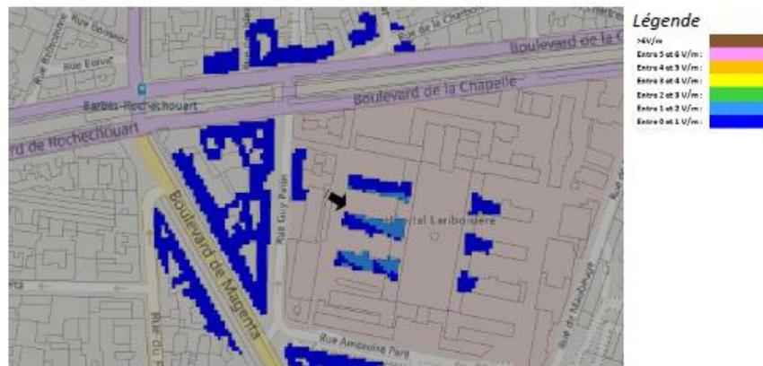
Pour les antennes à faisceau orientable dans l'azimut 240°, le niveau maximal calculé est compris entre 1 et 2 V/m . La hauteur correspondante est de 19.5 m .
