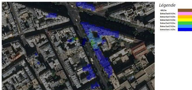
iv. Azimut 140°: antennes à faisceau orientable
