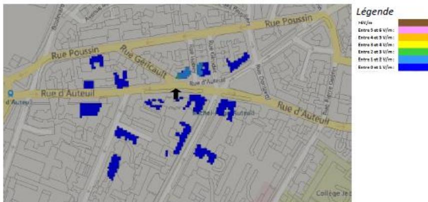
Pour les antennes à faisceau orientable dans l'azimut 120°, le niveau maximal calculé est compris entre 2 et 3 V/m . La hauteur correspondante est de 28.5 m .
