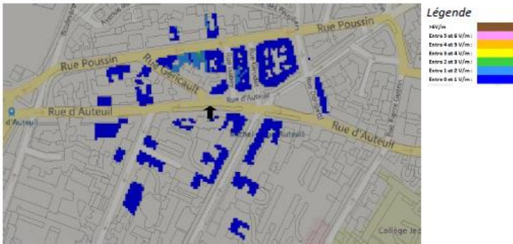
Pour les antennes à faisceau fixe orientées dans l'azimut 120°, le niveau maximal calculé est compris entre 3 et 4 V/m . La hauteur correspondante est de 28.5 m .
