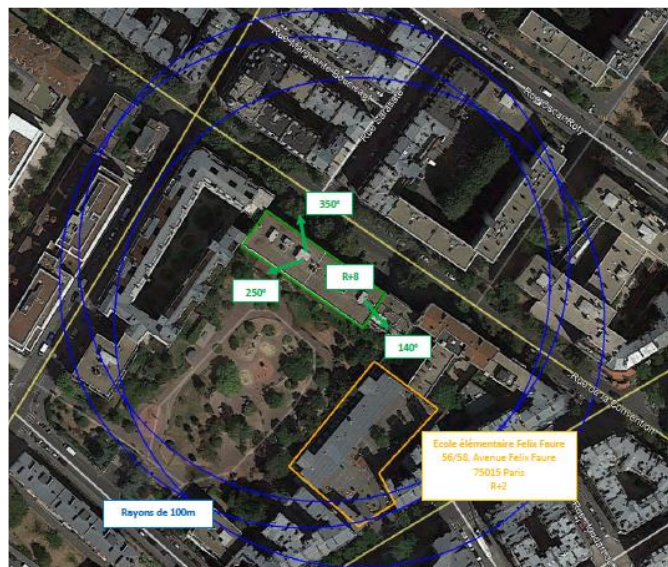
Adresses des établissements particuliers dont l'emprise est située à moins de 100 m et estimation du champ maximum reçu des antennes à faisceaux fixes dans chacun d'entre eux
