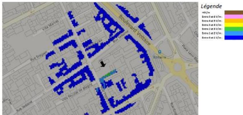
Pour les antennes à faisceau orientable dans l'azimut 270°, le niveau maximal calculé est compris entre 3 et 4 V/m . La hauteur correspondante est de 19.5 m .
