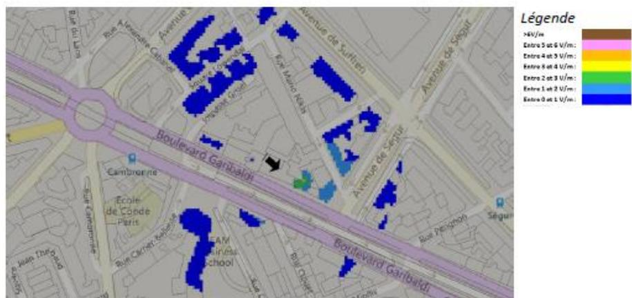
Pour les antennes à faisceau fixe orientées dans l'azimut 260°, le niveau maximal calculé est compris entre 1 et 2 V/m . La hauteur correspondante est de 19.5 m .
