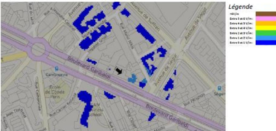
Pour les antennes à faisceau orientable dans l'azimut 260°, le niveau maximal calculé est compris entre 1 et 2 V/m . La hauteur correspondante est de 25.5 m .
