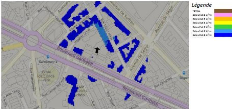
Pour les antennes à faisceau orientable dans l'azimut 130°, le niveau maximal calculé est compris entre 1 et 2 V/m . La hauteur correspondante est de 25.5 m .
