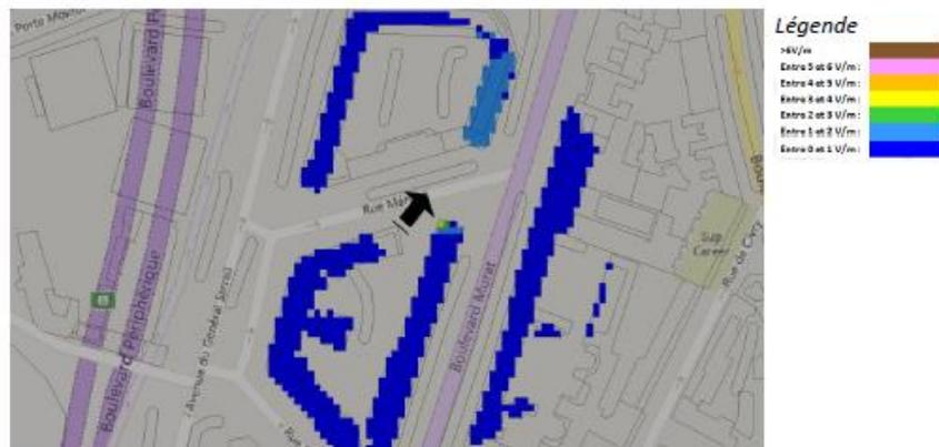
Pour les antennes à faisceau orientable dans l'azimut 290°, le niveau maximal calculé est compris entre 3 et 4 V/m. La hauteur correspondante est de 25.5 m.
