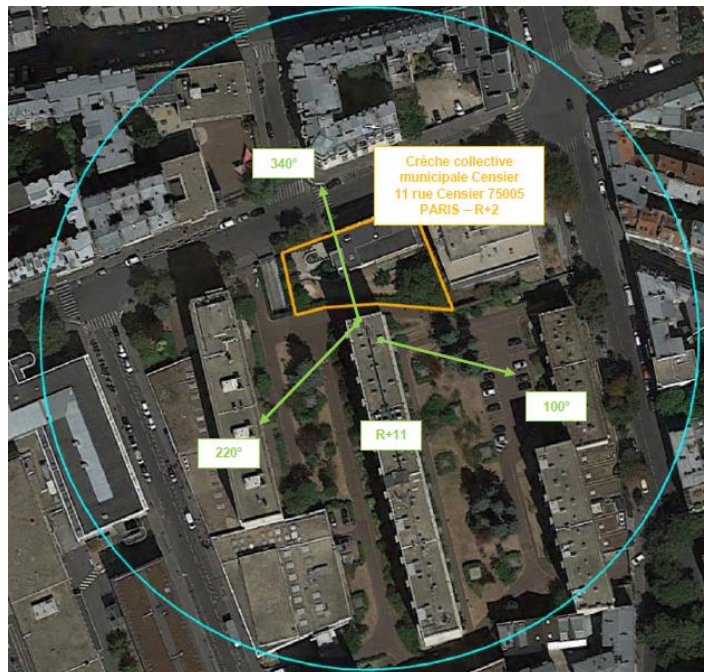
Adresses des établissements particuliers dont l'emprise est située à moins de 100 m et estimation du champ maximum reçu des antennes à faisceaux orientables dans chacun d'entre eux
