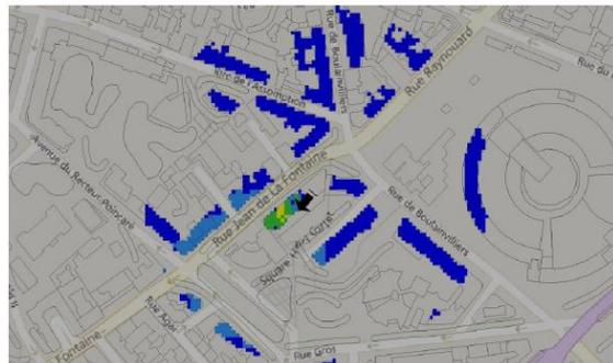
Pour les antennes à faisceau orientable dans l'azimut 340°, le niveau maximal calculé est compris entre 3 et 4 V/m. La hauteur correspondante est de 22.5 m.
