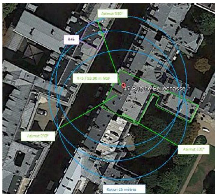
**Simulation et conformité au seuil de la Charte en 3G/4G/5G Faisceau fixe**
