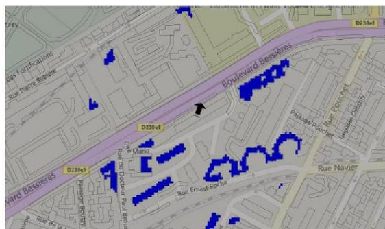
Pour les antennes à faisceau orientable dans l'azimut 180°, le niveau maximal calculé est compris entre 2 et 3 V/m . La hauteur correspondante est de 28.5 m .
