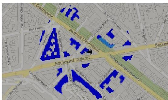
Pour les antennes à faisceau orientable dans l'azimut 220°, le niveau maximal calculé est compris entre 1 et 2 V/m . La hauteur correspondante est de 22.5 m .
