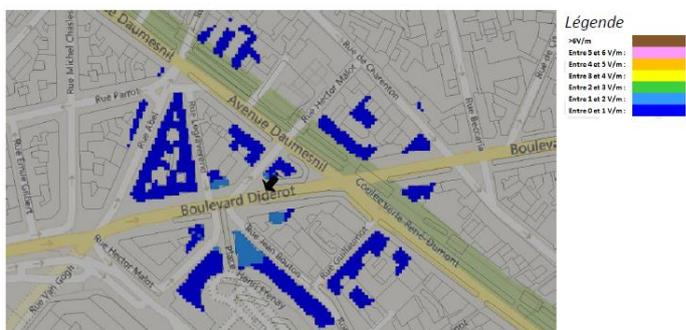
Pour les antennes à faisceau orientable dans l'azimut 340°, le niveau maximal calculé est compris entre 3 et 4 V/m . La hauteur correspondante est de 25.5 m .
