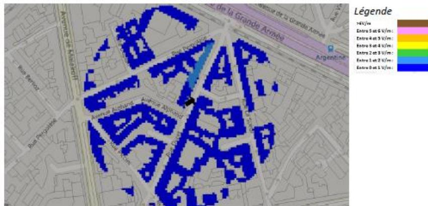
Pour les antennes à faisceau fixe orientées dans l'azimut 330°, le niveau maximal calculé est compris entre 1 et 2 V/m. La hauteur correspondante est de 19.5 m.
