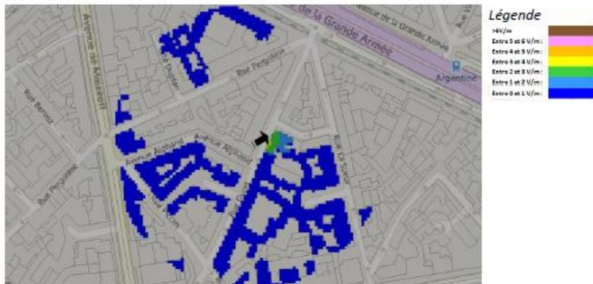
Pour les antennes à faisceau orientable dans l'azimut 330°, le niveau maximal calculé est compris entre 1 et 2 V/m . La hauteur correspondante est de 19.5 m .
