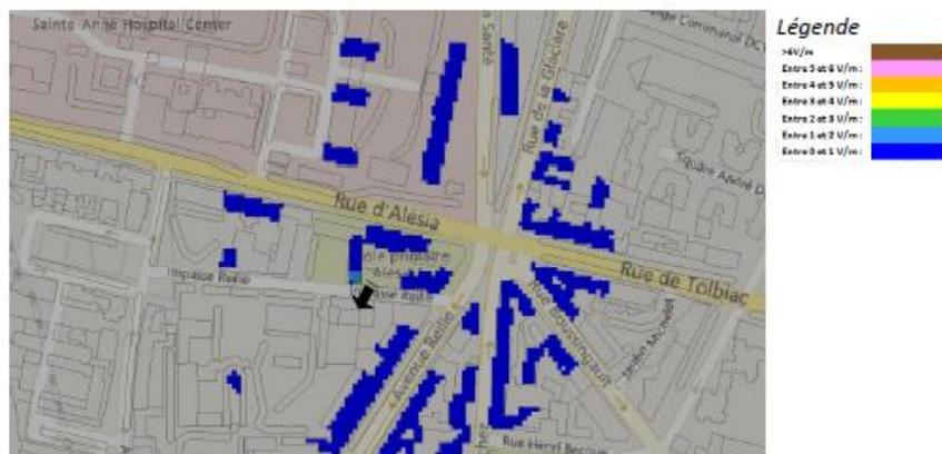
Pour les antennes à faisceau fixe orientées dans l'azimut 320°, le niveau maximal calculé est compris entre 2 et 3 V/m . La hauteur correspondante est de 13.5 m .
