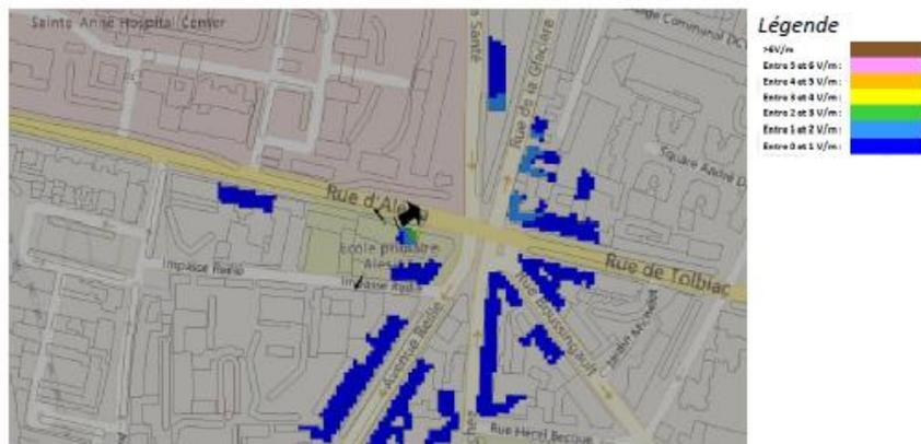
Pour les antennes à faisceau fixe orientées dans l'azimut 210°, le niveau maximal calculé est compris entre 2 et 3 V/m. La hauteur correspondante est de 16.5 m.
