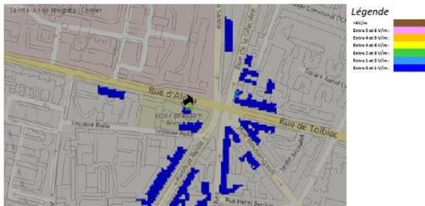
Pour les antennes à faisceau orientable dans l'azimut 210°, le niveau maximal calculé est compris entre 2 et 3 V/m . La hauteur correspondante est de 16.5 m .
