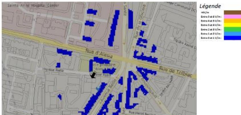
Pour les antennes à faisceau orientable dans l'azimut 320°, le niveau maximal calculé est compris entre 2 et 3 V/m. La hauteur correspondante est de 13.5 m.
