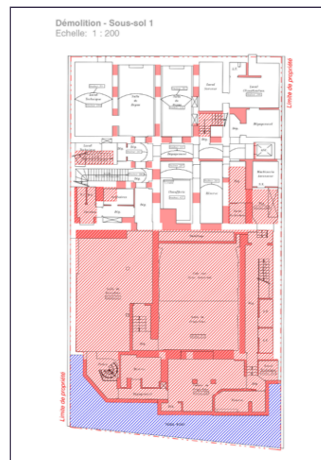
Plan du sous-sol présentant les démolitions envisagées (© SCAU architectes).
