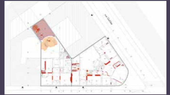
Plan du rez-de-chaussée, état existant présentant les démolitions envisagées (© CALQ).
