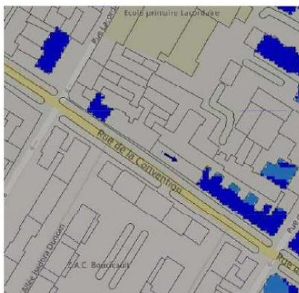
Pour l'antenne orientée dans l'azimut 240°, le niveau maximal calculé est compris entre 2 et 3 V/m. La hauteur correspondante est de 19.5m.
