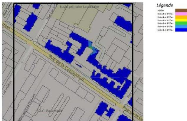
Pour l'antenne orientée dans l'azimut 240°, le niveau maximal calculé est compris entre 3 et 4 V/m. La hauteur correspondante est de 19.5 m.
