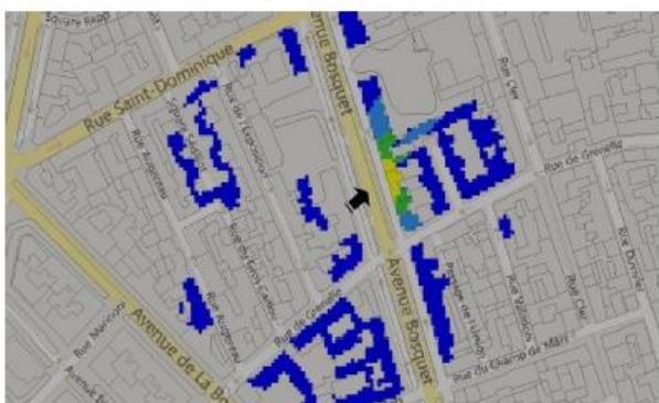
*Pour les antennes à faisceau fixe orientées dans l'azimut 270°, le niveau maximal calculé est compris entre 2 et 3 V/m. La hauteur correspondante est de 22.5 m.*
