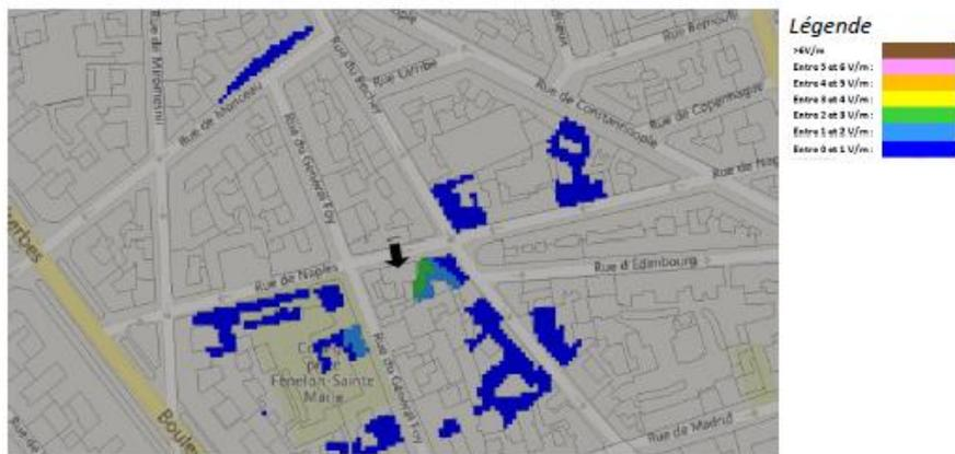
Pour les antennes à faisceau orientable dans l'azimut 280°, le niveau maximal calculé est compris entre 1 et 2 V/m . La hauteur correspondante est de 22.5 m .
