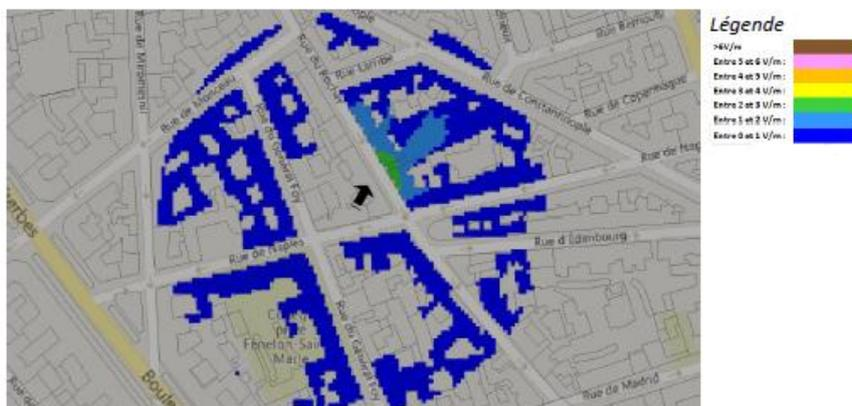
Pour les antennes à faisceau orientable dans l'azimut 170°, le niveau maximal calculé est compris entre 2 et 3 V/m . La hauteur correspondante est de 25.5 m .
